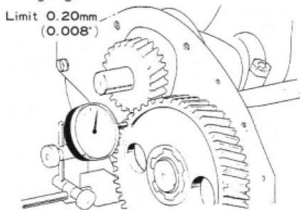
Fig.3-53 Checking Run-Out X4962
