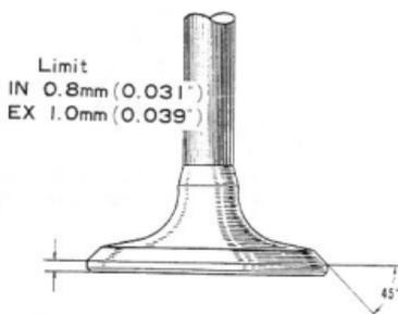
Fig.3-14 Valve Head Edge X0315
